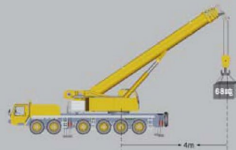
不挂平衡重最大力矩: 2734kN.m Max. load moment without counterweight
