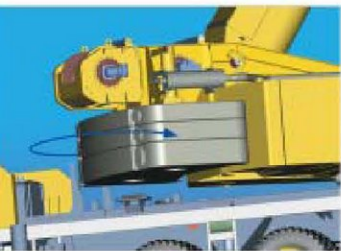
◆ 平衡尾部为弧形结构，尽可能缩小了回转作业空间 Curved counterweight tail reduced swing area
