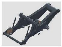
车架主体由变截面的箱形直纵梁和圆柱形横梁焊接而成,直纵梁设计消除了应力集中,变截面箱形纵梁结构降低了应力,延长了疲劳寿命,圆柱形的横梁结构使车架整体抗扭性能更加优越。车架采用先进焊接工艺,提高了焊缝的耐久性,延长了疲劳寿命。
