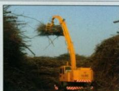
该产品是一种流动式装卸、堆垛和拆垛专用设备，含有多项专利技术。该产品采用折叠式吊臂，克服了汽车起重机软索起重时抓具易打转和作业时无下压力，而对较结实的物料抓取效果差等不足。是对草苇、木材、毛竹、废纸、土、砂、石等泡松散软原料进行装卸、堆垛和拆垛作业的最佳设备。
