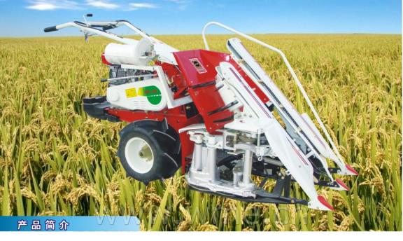
4K-50稻麦自动割捆机,引进国外技术生产,国内独一机型,设计精巧,结构精密,性能可靠,质量稳定,带有差速转向功能,特别适用于山地、丘陵地区及东北大部分地区的小麦、水稻、蒲草、谷物等低杆作物的收割捆放,突出特点是割的干净,割茬低,自动打捆,自动抛放,适应于成捆存放的农作物,是水稻、小麦等作物收割打捆的理想机具,可以大大降低劳动强度,提高生产效率。
