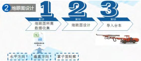
全自动钻孔:1、选择孔序 2、有序钻孔凿岩
