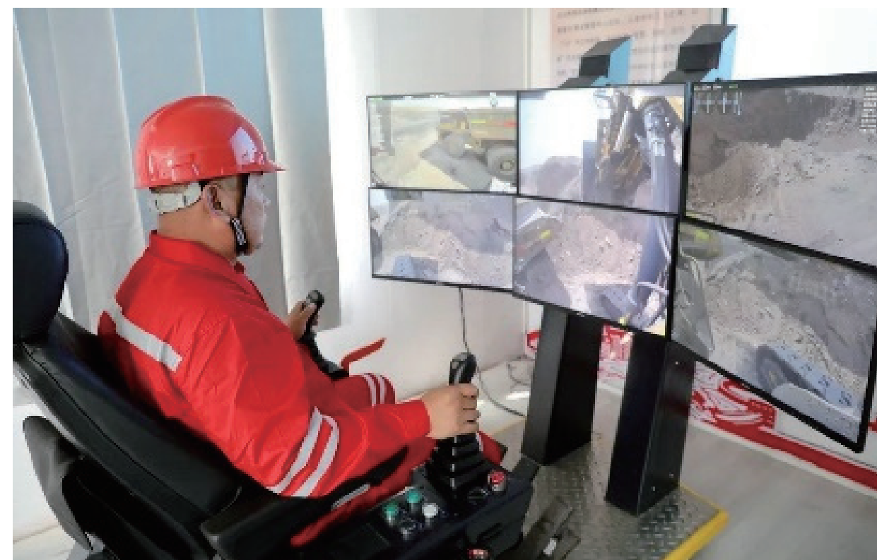
徐工远程操控 XE7000 矿用挖掘机在内蒙古露天煤矿执行挖装任务
